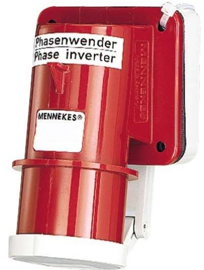
Mennekes Aufbaustecker 32A,5p,6h,400V,IP44 21241 IEC-Stromstärke 32A, Polzahl 5, Spannung nach EN 60309-2 400 V (50+60 Hz) rot, Uhrzeit-Stellung 6h, Kennfarbe rot, Schutzart (IP) IP44, Anschlussstechnik Schraubklemme, Bauform Aufbaugerätestecker, Phasenwender, Steckrichtung rechtwinklig, Werkstoff Kunststoff,
