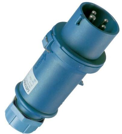
Mennekes Stecker StarTOP 16A,4p,9h,230V,IP44 951 IEC-Stromstärke 16A, Polzahl 4, Spannung nach EN 60309-2 230 V (50+60 Hz) blau, Uhrzeit-Stellung 9h, Kennfarbe blau, Schutzart (IP) IP44, Anschlussstechnik schraublose Klemme, Kabeleinführung Verschraubung, Steckrichtung gerade, Werkstoff Kunststoff,
