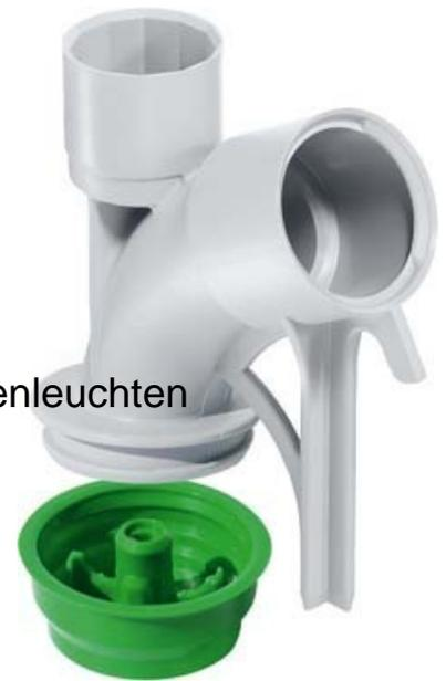
Kaiser Wand/Deckenkrümmer 1202-04 Ausführung der Leitung Rohr, Montageart Beton, Anzahl der Einführungen 1, Auslasslänge 70mm, Auslassbreite 30mm, Auslassdurchmesser 20mm, Wand- und Deckenkrümmer 30° für DIN EN Rohr Außen-Ø 20,0 mm, Einbauhöhe 62 mm, zum Verbinden von Rohren oder als Deckenauslass, zur Schalungsseite mit Putzhaut verschlossen, halogenfrei
