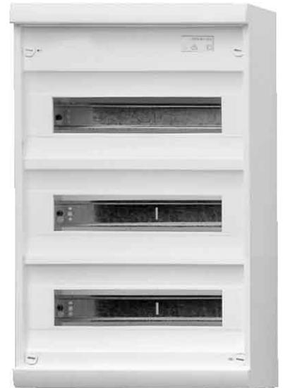
ABN Braun Kleinverteiler A36A Anzahl der Reihen 3, Breite in Teilungseinheiten 36, Ausführung Deckel mit Ausschnitt, Werkstoff des Gehäuses Kunststoff, Höhe 495mm, Breite 300mm, Einbautiefe 106mm, DIN-Schiene,
